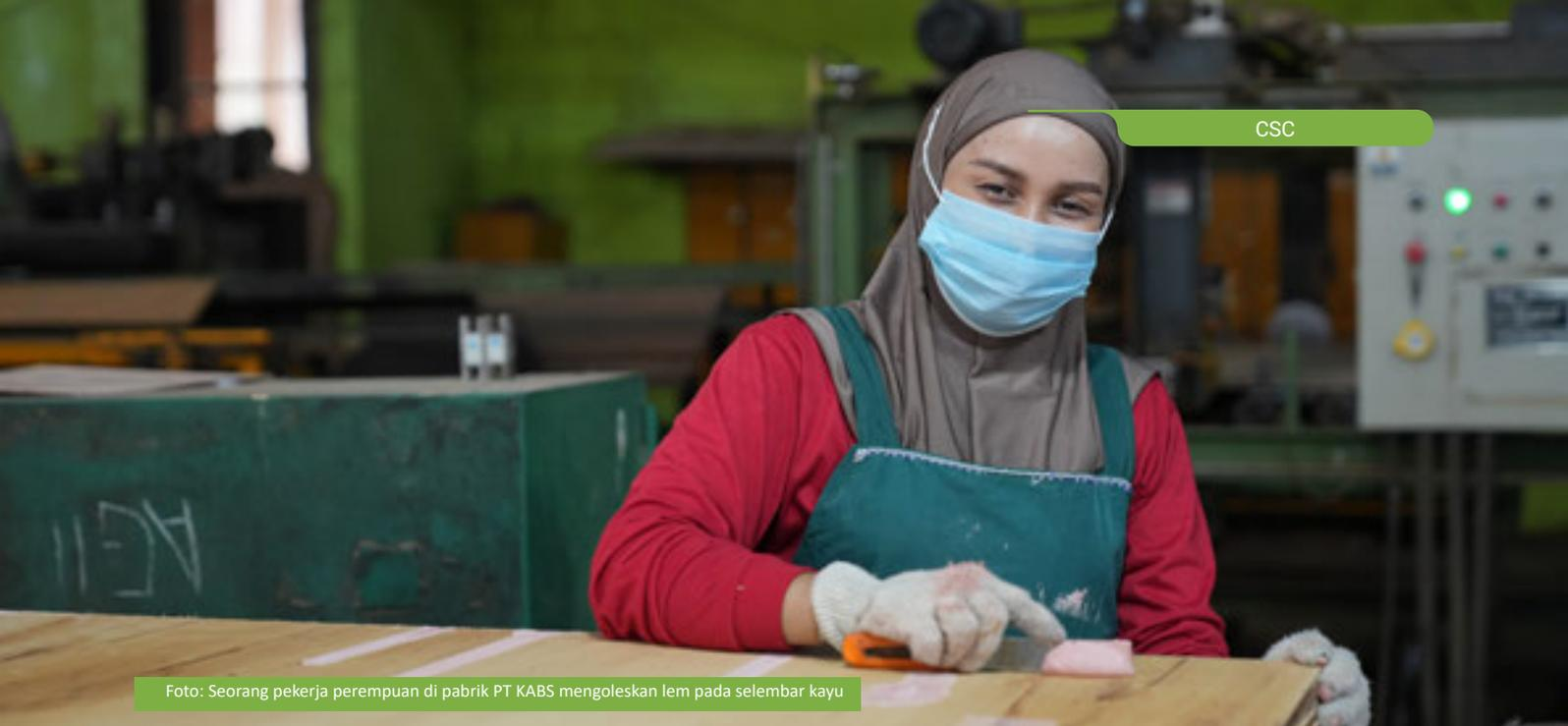
Foto: Seorang pekerja perempuan di pabrik PT KABS mengoleskan lem pada selembur kayu
